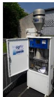
Figure 3 : Appareil de prélèvement de particules sur filtre pour la caractérisation chimique des particules
