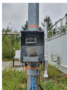
Figure 11. Installation d'un système d'échantillonnage de l'ammoniac gazeux et de l'ammonium particulaire (DELTA® UKCEH) sur le site MERA de Revin
