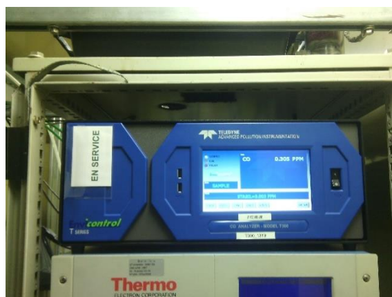
Figure 8: Appareil de mesure de CO nommé T300 (source: Qualitair Corse)
