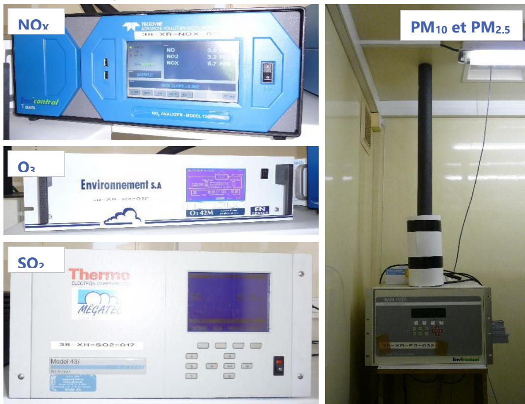
Figure 3: Exemple d'analyseurs pour chaque polluant mesuré (Crédits : ©Atmo Réunion).
