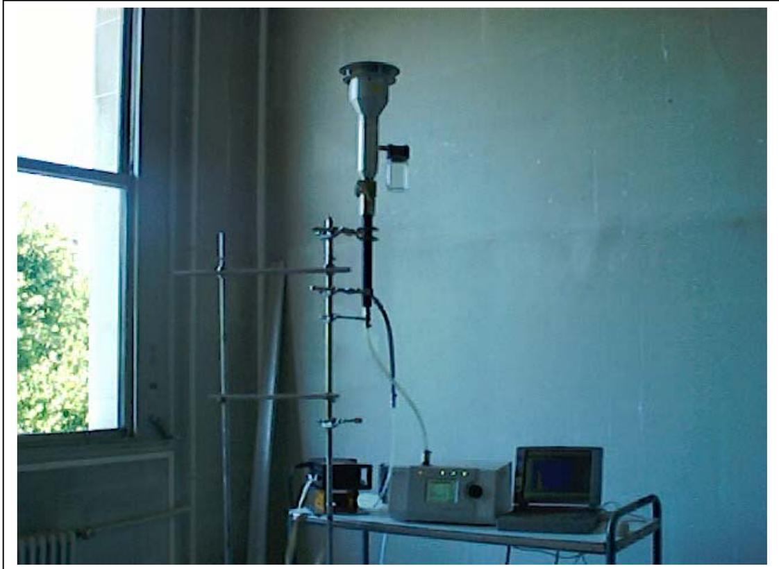
Figure n°8 : Montage du système têtes de prélèvement / APS (ici avec la PM<sub>2,5</sub>).
