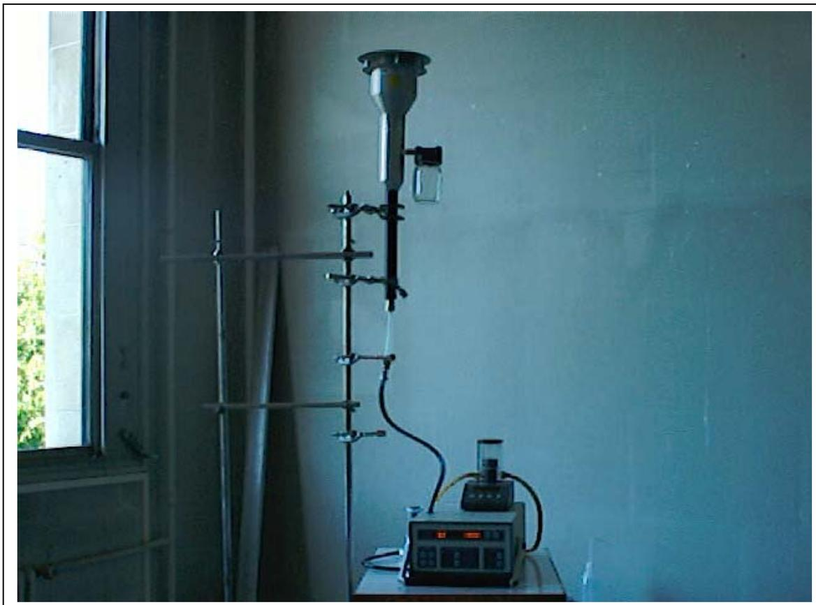
Figure n°7 : Montage du système têtes de prélèvement / COP (ici avec la PM<sub>10</sub> n°1).
