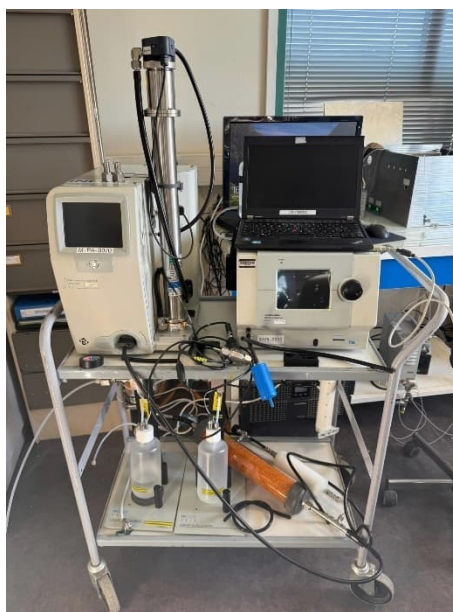
Figure 3: Dispositif d'étalonnage expérimental de l'ACMCC
