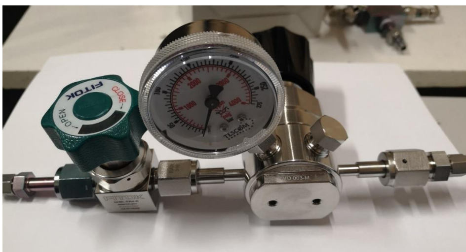
Figure 3 : Détendeur et vanne d'isolement utilisés lors de la campagne d'analyse de l'air zéro des AASQA de 2022
