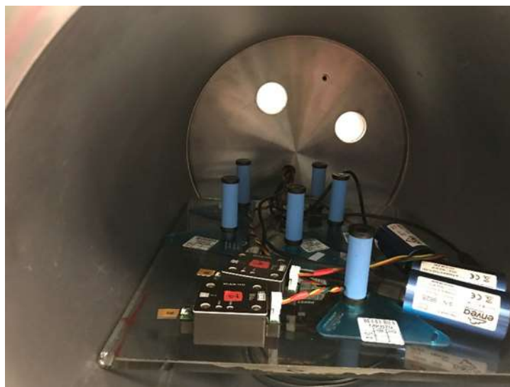
Figure 29 : Configuration de la chambre d'exposition revêtue en SilcoNert® 2000 avec des échantillonneurs passifs Radiello® 168 et des capteurs d'ammoniac développés à l'IMT Nord Europe et commercialisés par Envea (CairSens NH 3 ).
