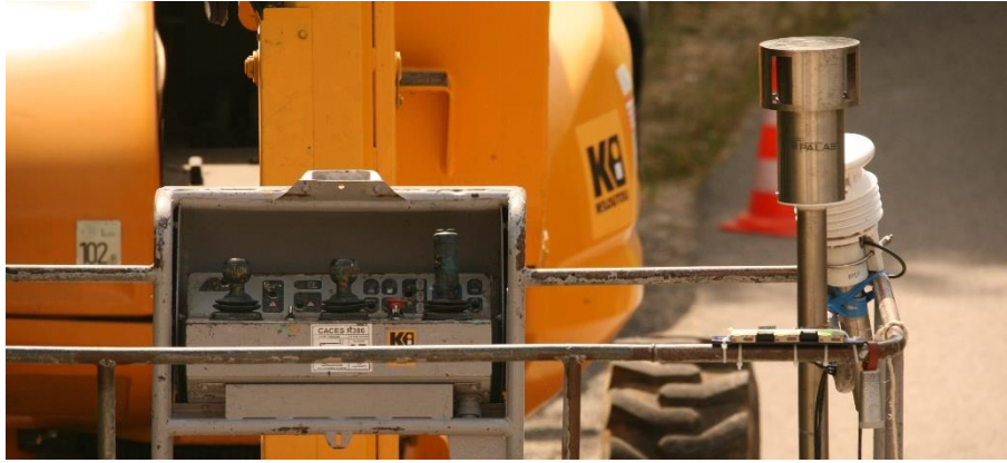
Figure 3a : Vue de la 1 ère disposition des appareils de mesures sur le panier de la nacelle, « FIDAS et capteurs côte à côte ».
