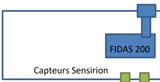
Figure 2b : Schéma de la 1 ère disposition des appareils de mesures sur le panier de la nacelle, « FIDAS et capteurs côte à côte ».
