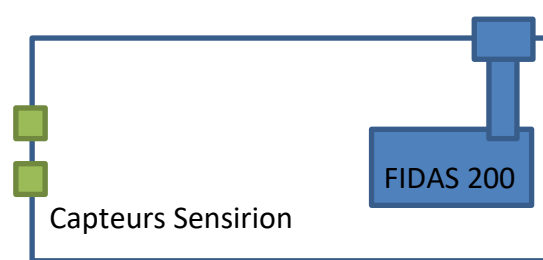
Figure 3c : Schéma de la 2 ème disposition des appareils de mesures sur le panier de la nacelle, « FIDAS et capteurs opposés ».
