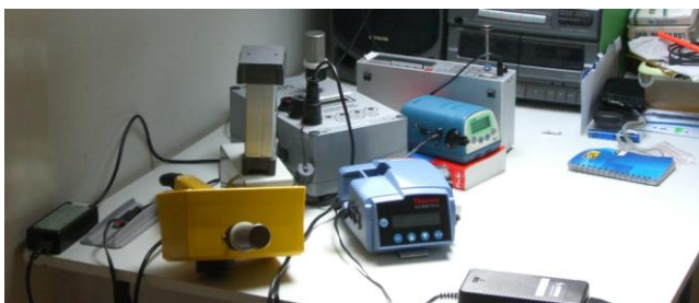
Chambre : Disposition des indicateurs optiques et de la source d'encens
