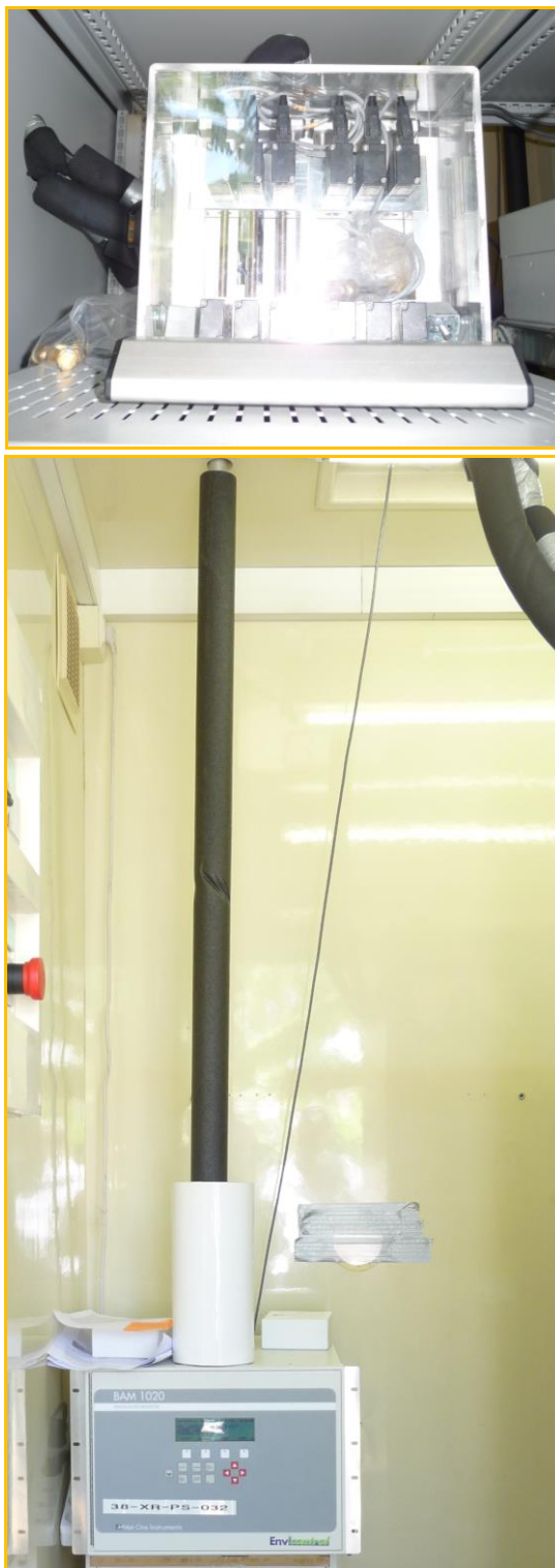
Figure 26 : Photographie du préleveur de BTEX (a) et de l'analyseur des PM (a) en fonctionnement dans la station JOI.
