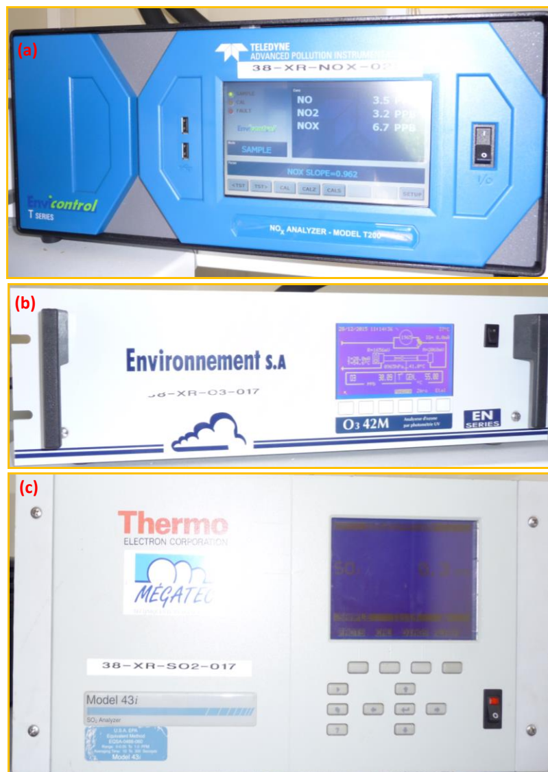
Figure 47 : Photographie des analyseurs NO x (a), O 3 (b), et SO 2 (c) en fonctionnement dans la station PCA.
