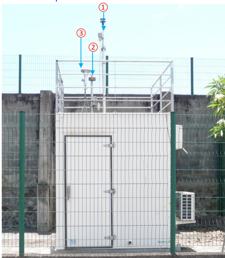
Figure 17 : Photographie présentant les têtes de prélèvements sur la station LIS.
