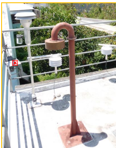
Figure 40 : Photographie des têtes de prélèvements sur la station JOI.
