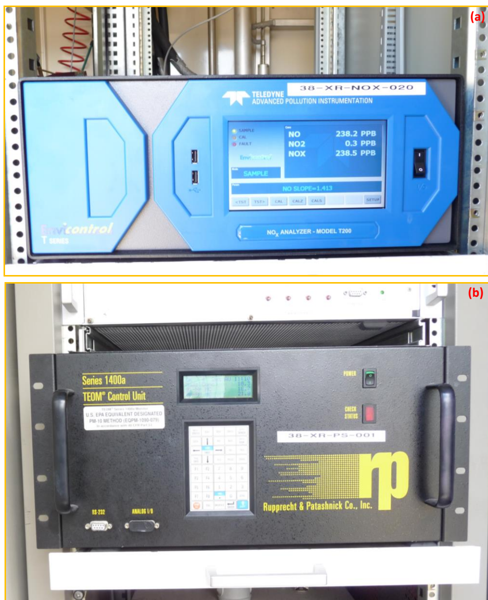
Figure 4 : Photographie des analyseurs NO x (a) et PM 10 (b) en fonctionnement dans la station LIS.
