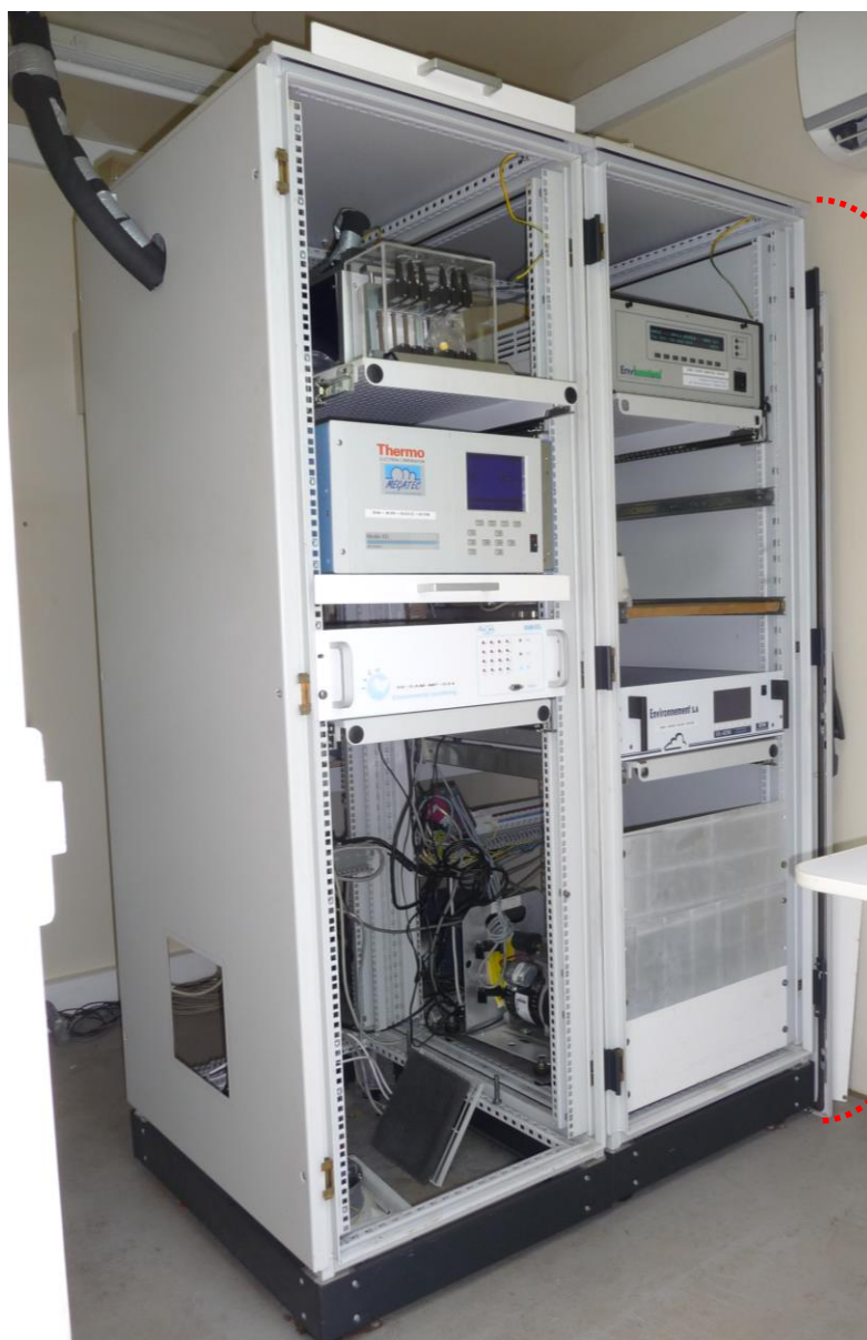
Figure 37 : Photographie de la baie de mesures dans laquelle sont installés les analyseurs de la station JOI.
