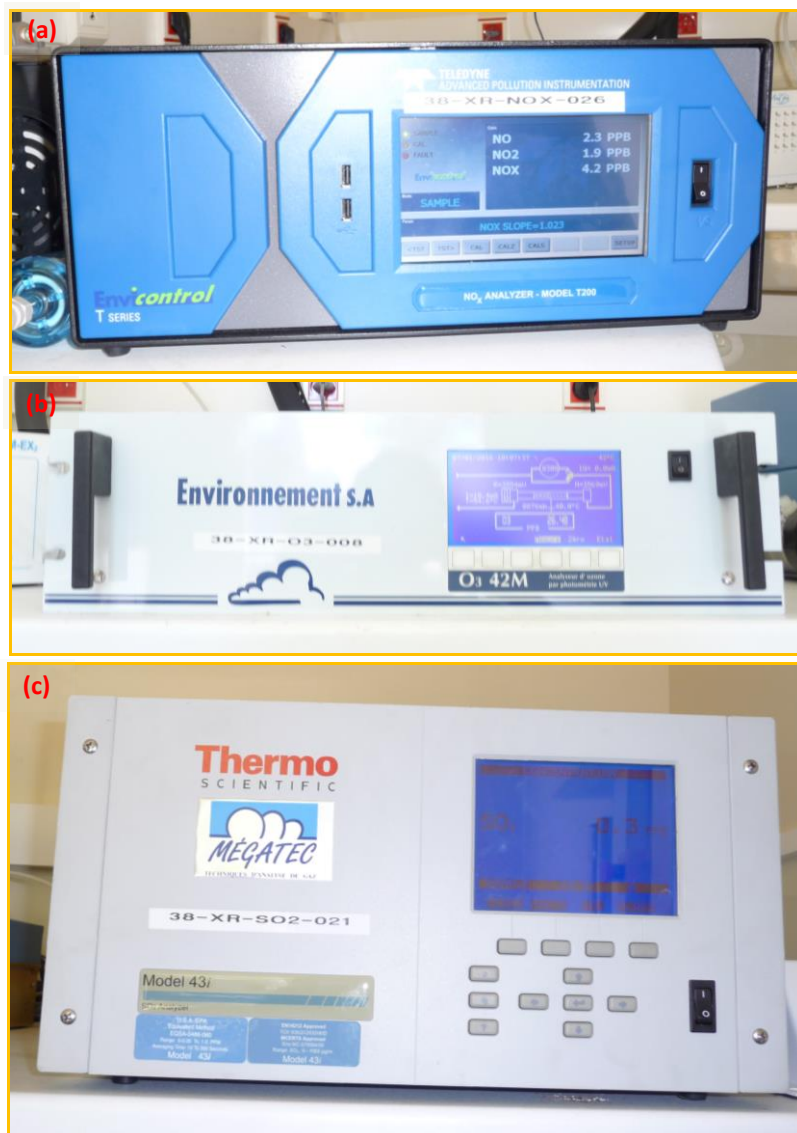
Figure 66 : Photographie des analyseurs NO x (a), O 3 (b), et SO 2 (c) en fonctionnement dans la station LUT.
