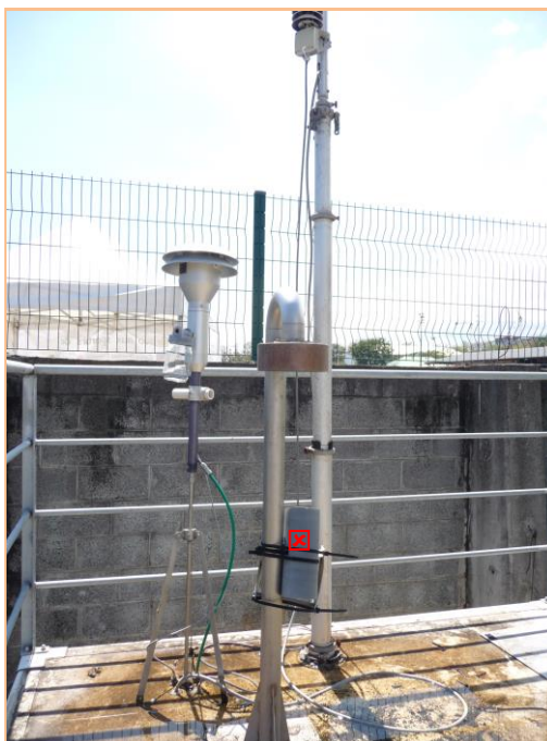
Figure 18 : Photographie des têtes de prélèvements sur la station LIS.
