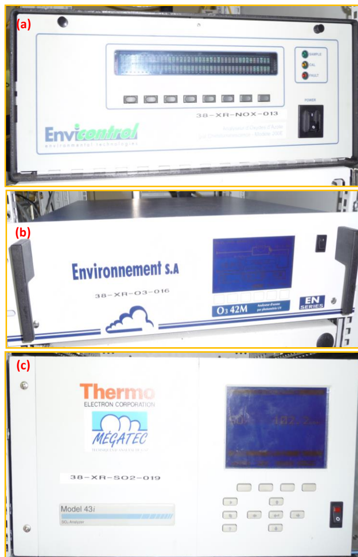
Figure 25: Photographie des analyseurs NO x (a), O 3 (b), et SO 2 (c) en fonctionnement dans la station JOI.
