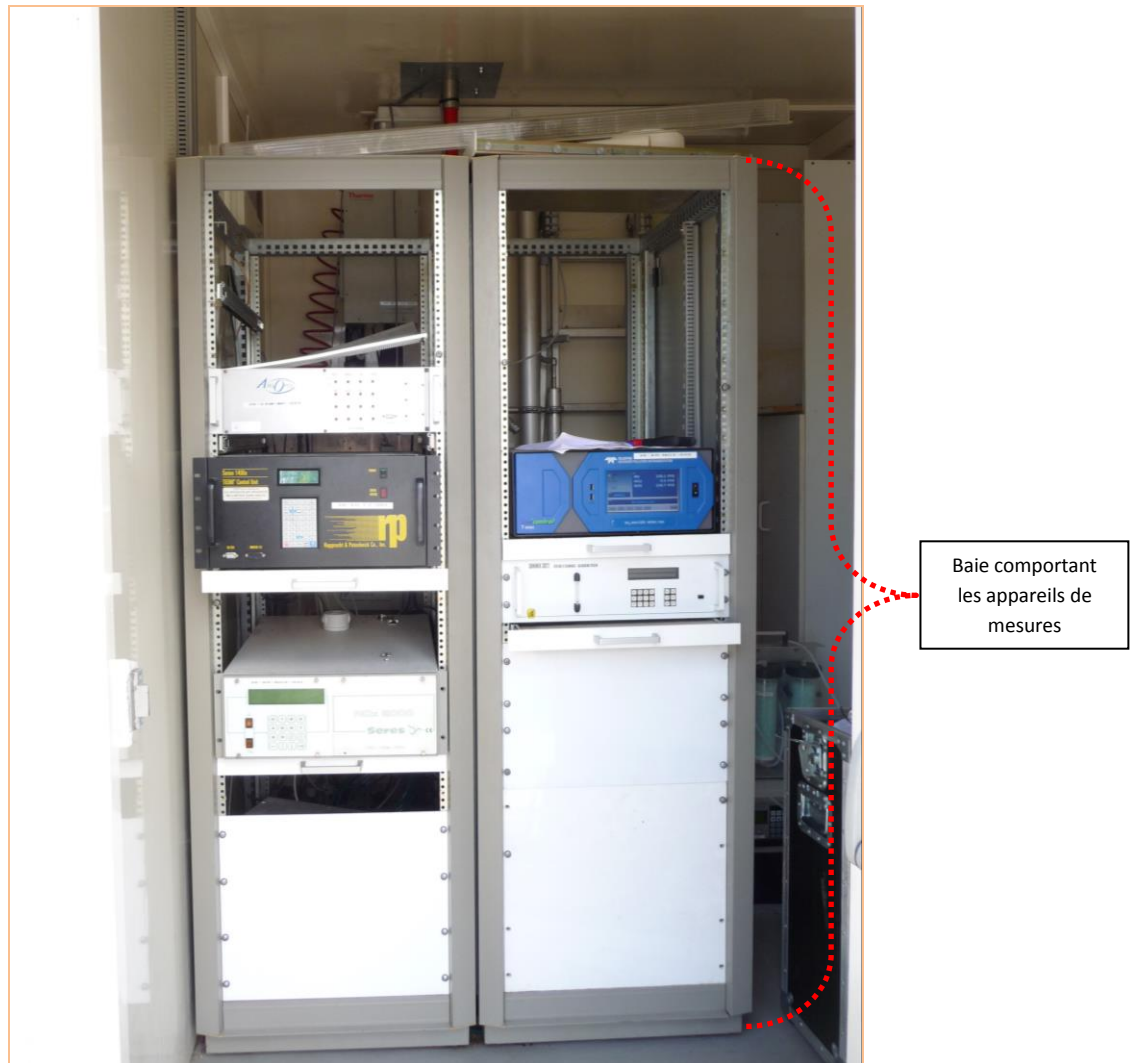
Figure 15 : Photographie de la baie de mesure dans laquelle sont installés les analyseurs de la station LIS.
