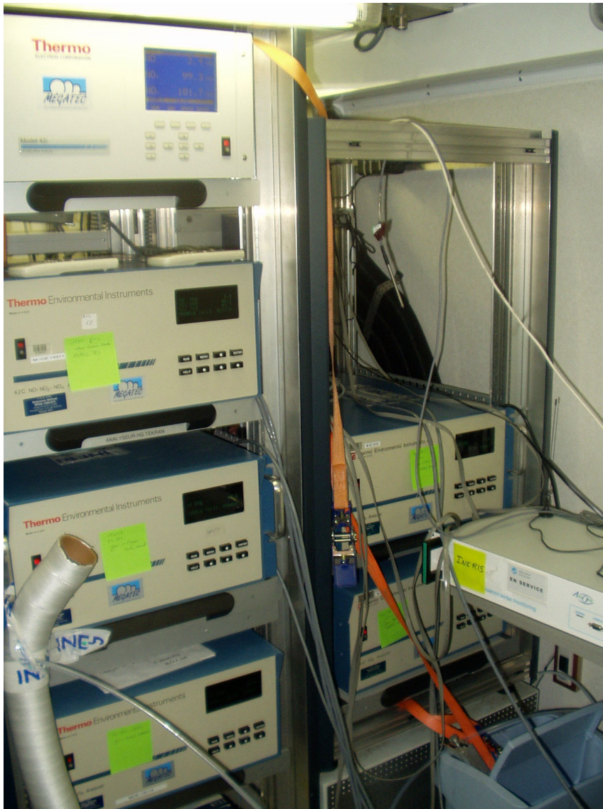
Analyseurs testés et interrogés par Modem GSM par la station d'acquisition ISEO-SAM
