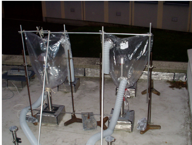
Photo des deux sacs à gaz enveloppant deux têtes de prélèvement « A » et « B »
