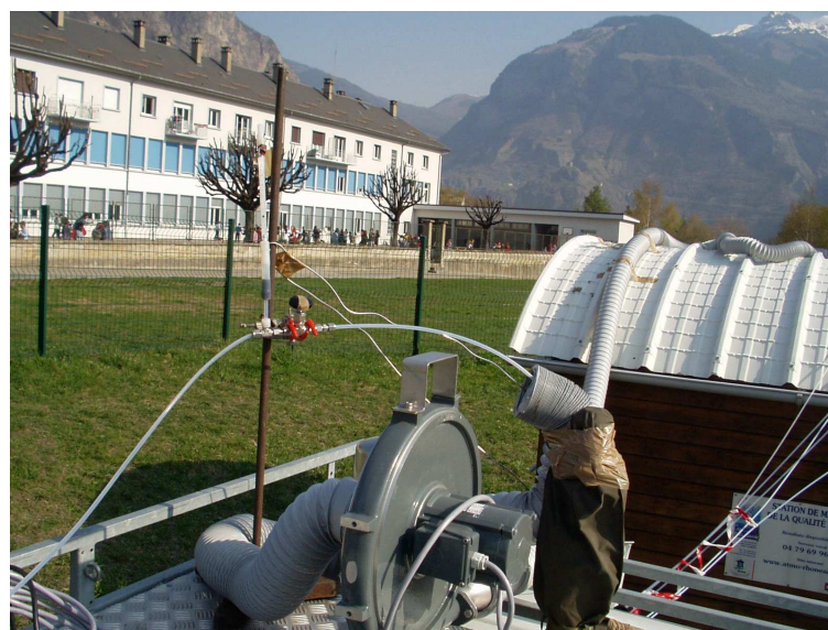
Photo 3.3 : ventilateur et entrée des gaz de dopage.
