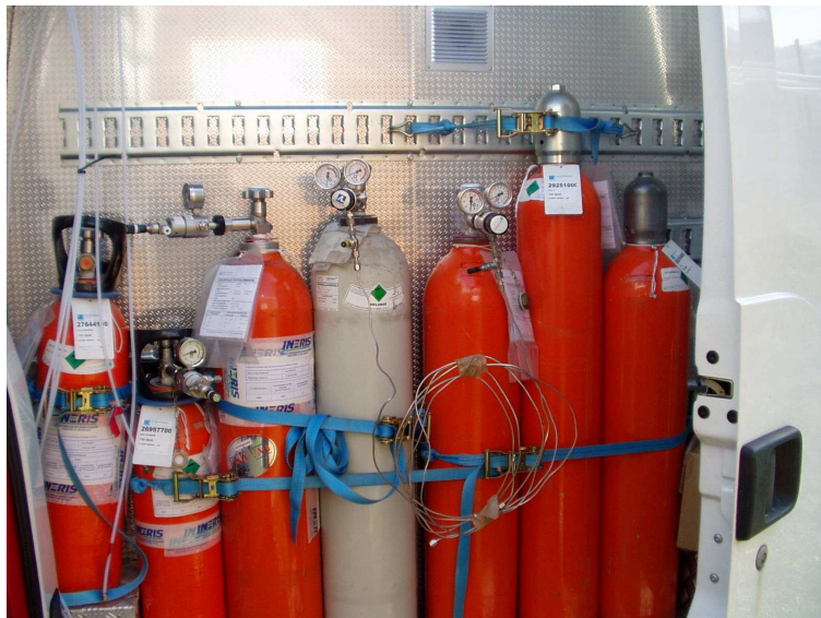
Photo 3.5: bouteilles « haute concentration » utilisées pour le dopage et bouteilles raccordées à la chaîne nationale d'étalonnage pour les réglages des analyseurs.
