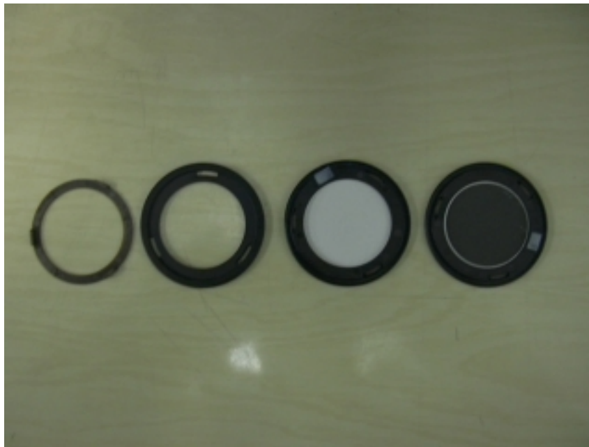
Figure 19 : Coupelle porte-filtre du PM162M (démontée, avec filtre vierge, avec filtre empoussiéré)
