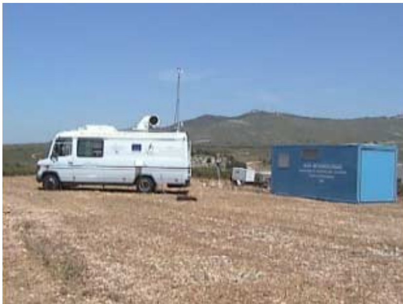
Figure 28 : photographie du LIDAR angulaire INERIS/UCLO installé sur le site du Vallon Dol, du 20 juin au 16 juillet 2001. L’algéco bleu correspond au LIDAR LVT
