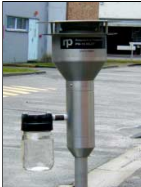
Figure 1 : tête d'échantillonnage \text{PM}_{10}
