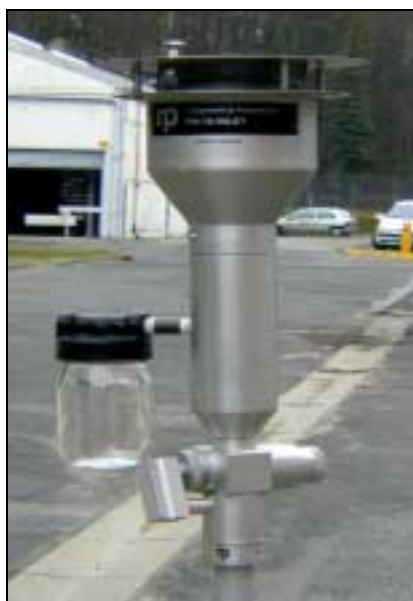
Figure 2 : Sharp-Cut Cyclone - tête d'échantillonnage PM_{2.5}
