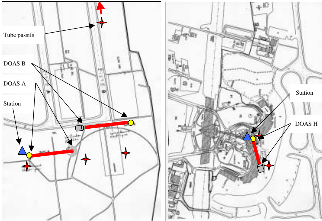
Instrumentation de la zone aéroportuaire : sites des 3 DOAS, Tubes passifs, stations
