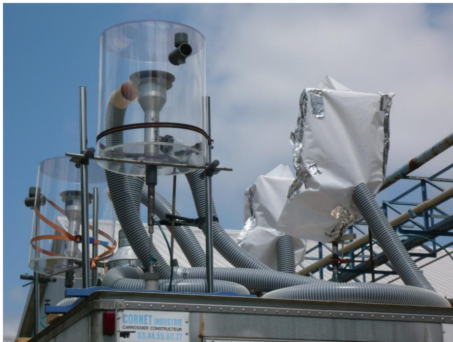
Figure 3 : Dispositif de distribution, sur le toit de la station mobile INERIS (vue n°1)
