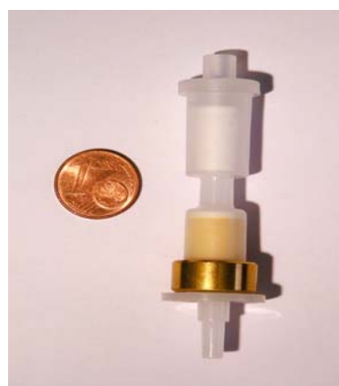
Figure 3 : Schéma d'un piège à ozone (gauche) et photographie d'un piège à ozone placé en amont des tubes de prélèvement actifs (Sep-Pack® et LpDNPH®)
