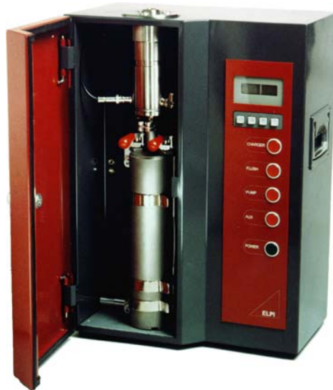
Figure A12 : Impacteur basse pression à détection électrique ELPI
