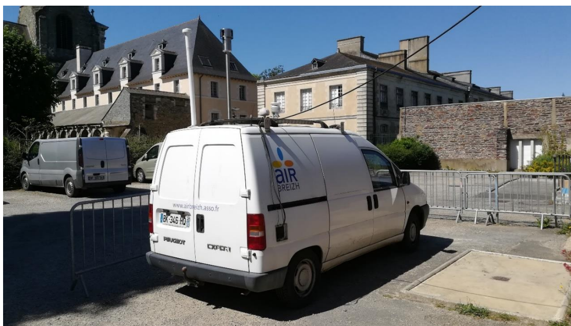
Figure 7 : Camion laboratoire abritant les instruments de mesure utilisés pendant la campagne
