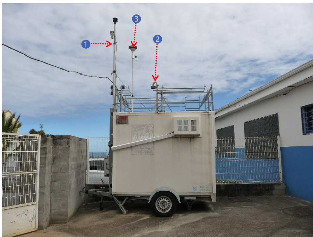
Figure 16 : Têtes de prélèvements sur la station MOB (orientation Nord) (Crédit photo : ©Atmo Réunion, 2020).
