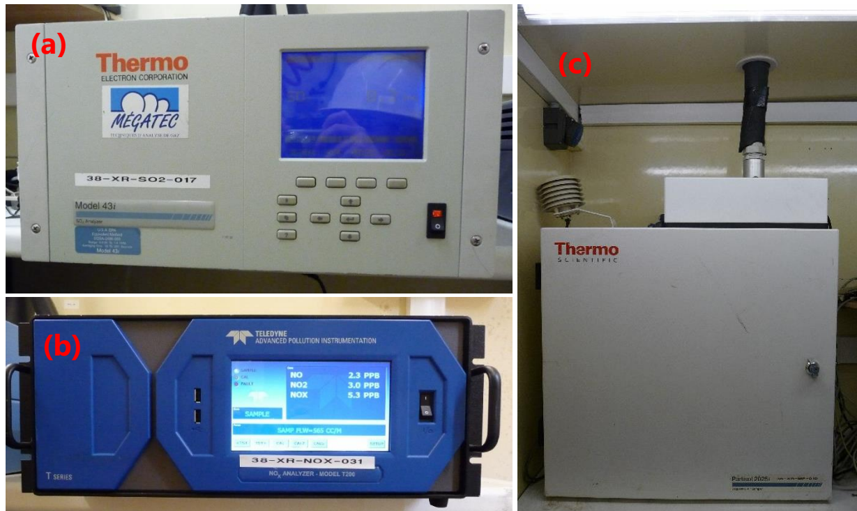
Figure 3 : Analyseurs (a) SO 2 , (b) NO x et (c) HAP en fonctionnement dans la station MOB ( Credits photos : ©Atmo Réunion, 2020).
