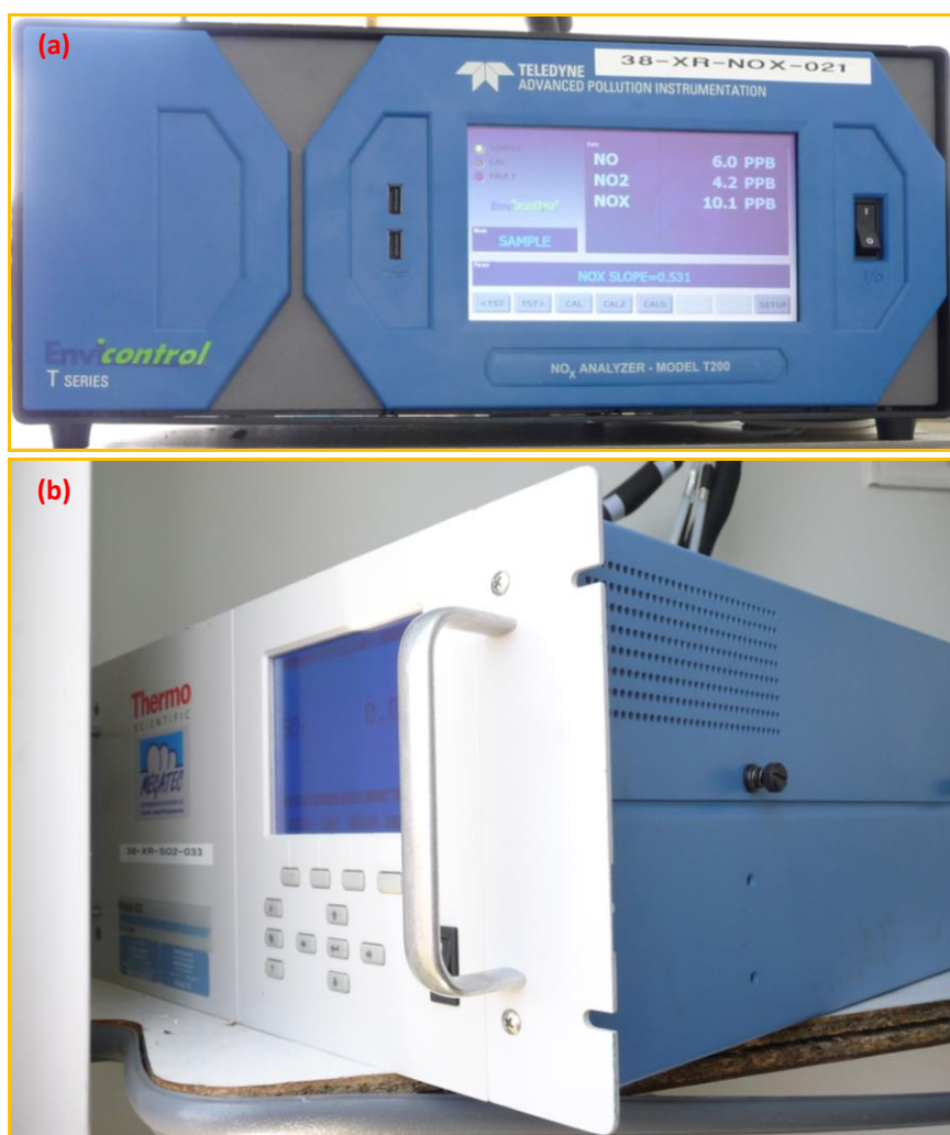
Figure 3 : Photographie des analyseurs NO x (a) et SO 2 (b) en fonctionnement dans la station MQT.
