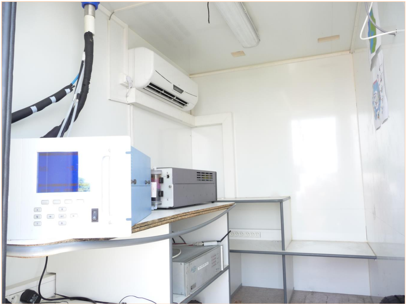
Figure 12 : Photographie de la paillasse sur laquelle sont installés les analyseurs SO 2 et NO x de la station MQT.
