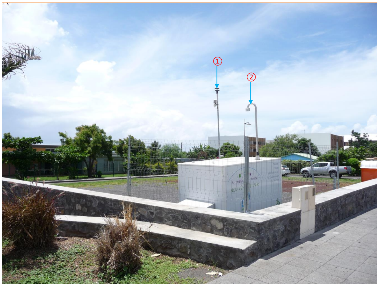
Figure 14 : Photographie présentant les têtes de prélèvements sur la station MQT.
