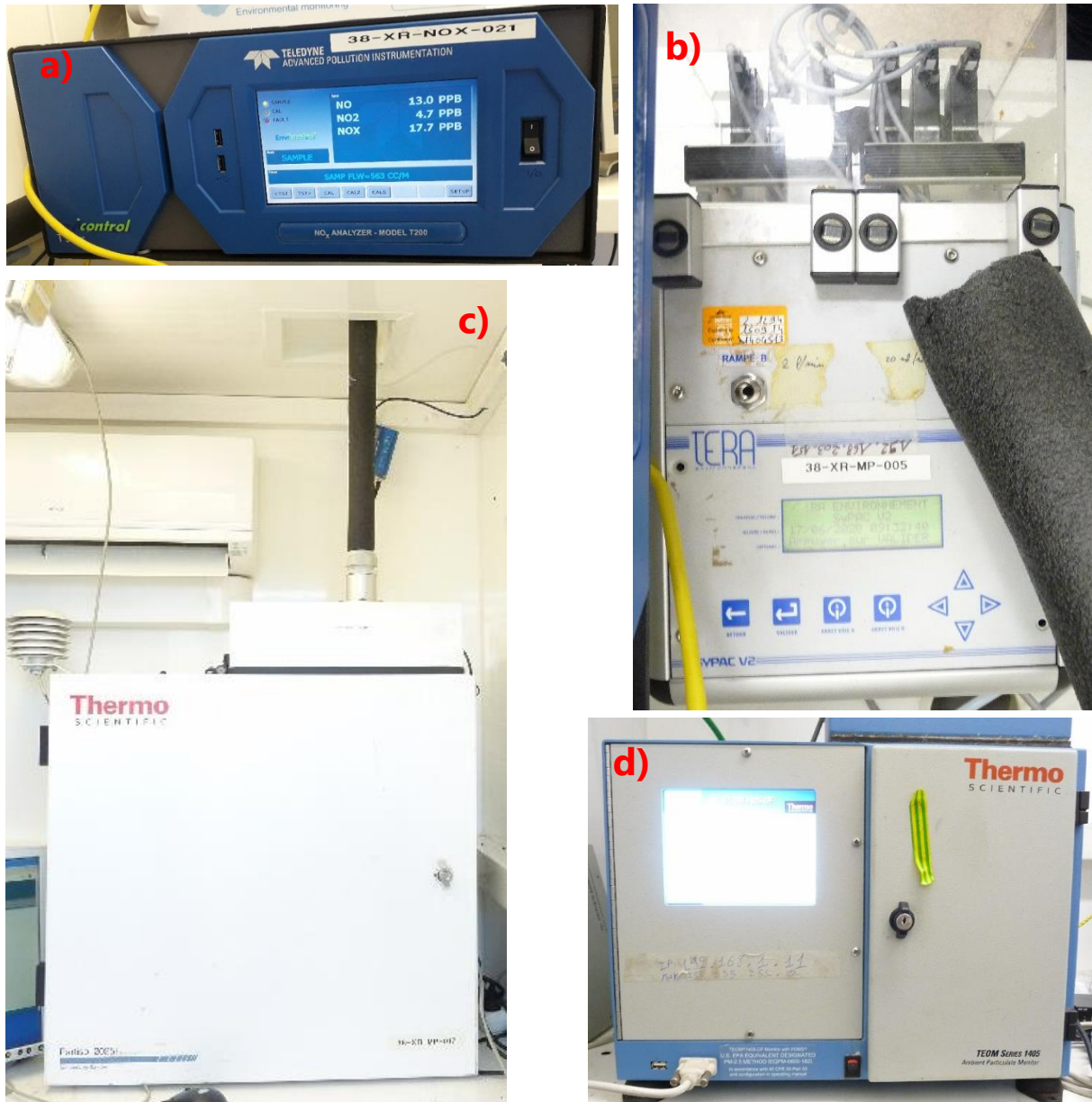
Figure 3 : Analyseurs (a) NO x , (b) Benzène, (c) HAP, (d) PM10 et PM2.5 en fonctionnement dans la station RDT (Crédits photos : ©Atmo Réunion, 2020).
