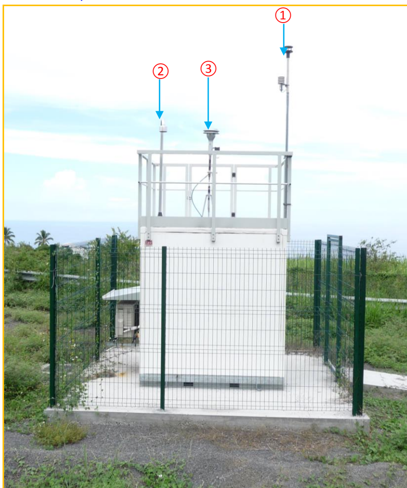
Figure 14 : Photographie présentant les têtes de prélèvements sur la station RDT (orientation sud-ouest).
