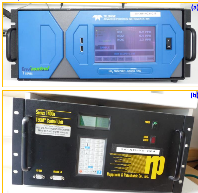
Figure 3 : Photographie des analyseurs NO x (a) et PM 10 (b) en fonctionnement dans la station RDT.
