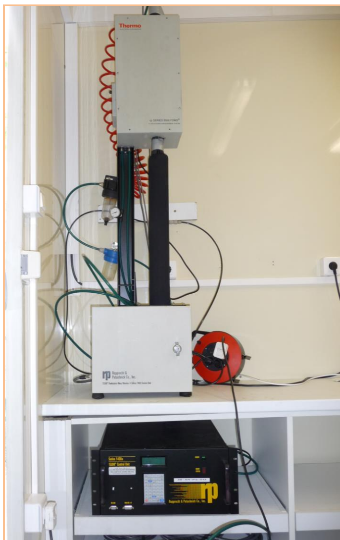
Figure 13 : Photographie de la paillasse sur laquelle sont installés les analyseurs NOx et PM10 de la station ROY.
