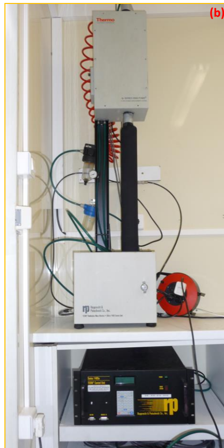
Figure 3 : Photographie des analyseurs NOx (a) et PM10 (b) en fonctionnement dans la station ROY.
