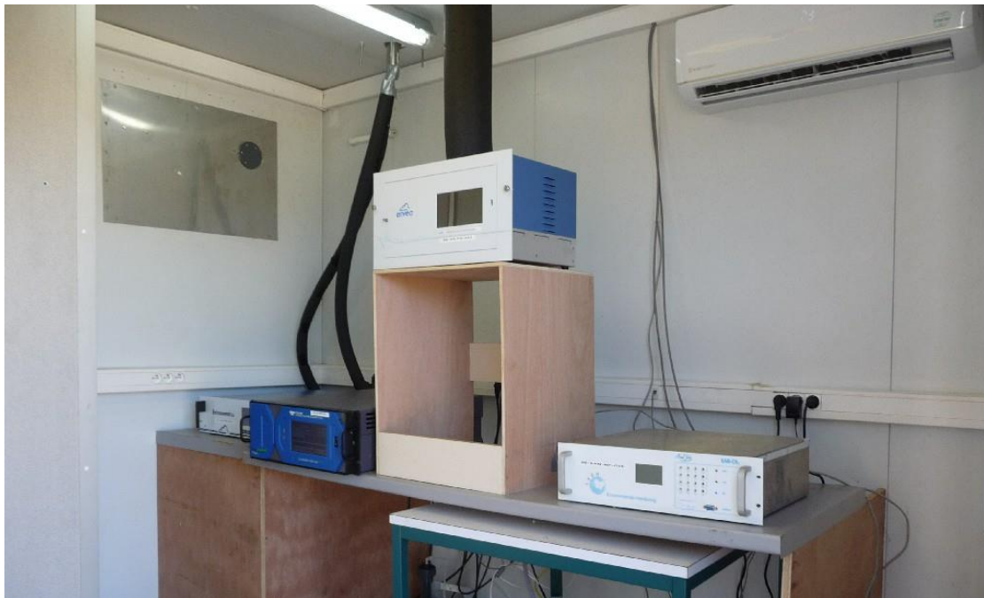
Figure 12 : Paillasse sur laquelle sont installés les analyseurs NO x , O 3 et PM 10 de la station GFO ( Crédit photo : ©Atmo Réunion, 2020).
