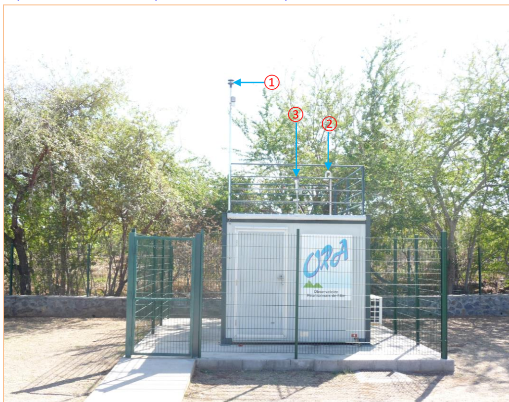
Figure 15 : Photographie présentant les têtes de prélèvements sur la station GFO (orientation Nord).
