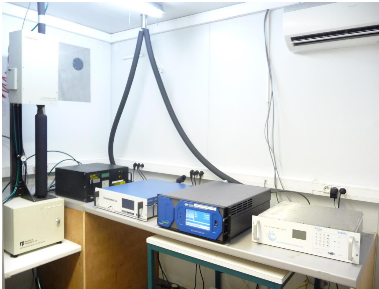
Figure 13 : Photographie de la paillasse sur laquelle sont installés les analyseurs NO x , O 3 et PM10 de la station GFO.
