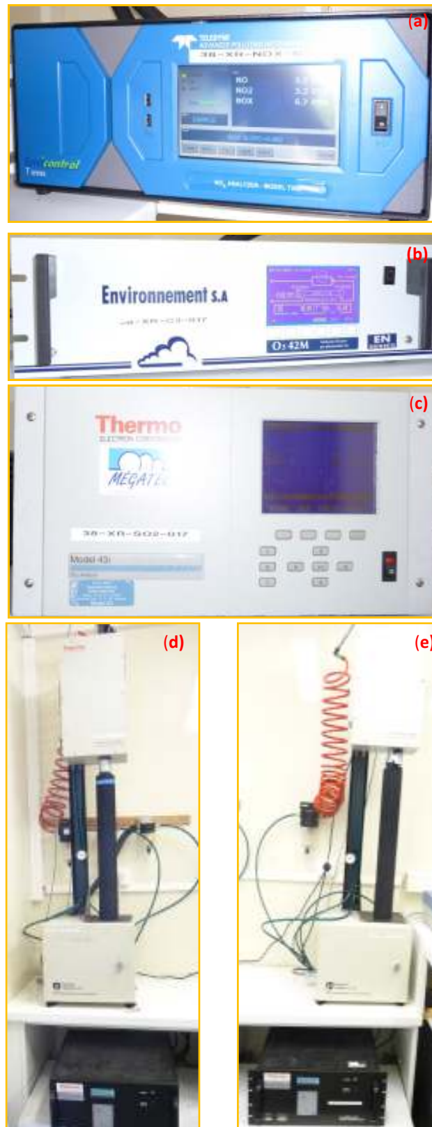
Figure 3 : Photographie des analyseurs NO x (a), O 3 (b), SO 2 (c), PM 2.5 (d) et PM 10 (e) en fonctionnement dans la station PCA.
