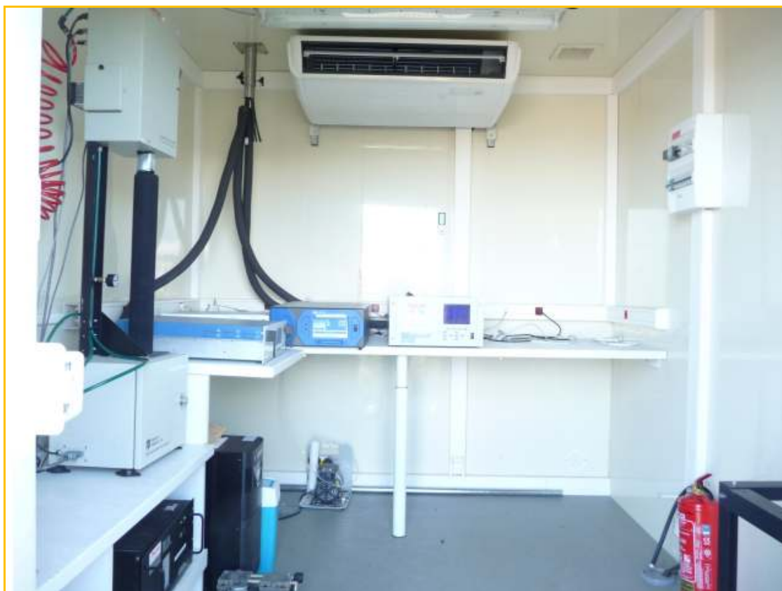
Figure 15 : Photographie de la paillasse sur laquelle sont installés les analyseurs de la station PCA.
