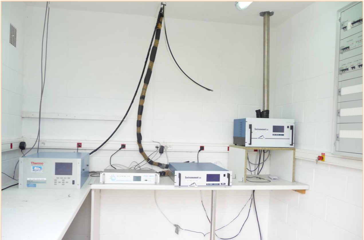
Figure 18 : Photographie de la paillasse sur laquelle sont installés les analyseurs \text{SO}_2 , \text{O}_3 et \text{PM}_{10} de la station BMU.
