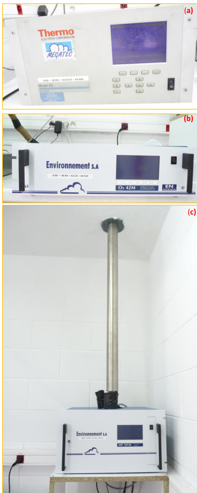
Figure 3 : Photographie des analyseurs \text{SO}_2 (a), \text{O}_3 (b) et \text{PM}_{10} (c) en fonctionnement dans la station BMU.
