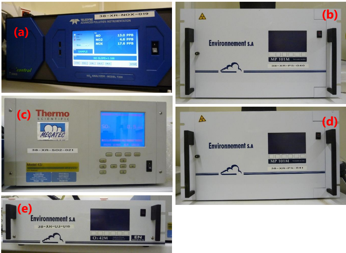
Figure 3 : Analyseurs (a) NO x , (b) PM 2.5 , (c) SO 2 , (d) PM 10 et (e) O 3 en fonctionnement dans la station LUT ( Crédits photos : ©Atmo Réunion, 2020).
