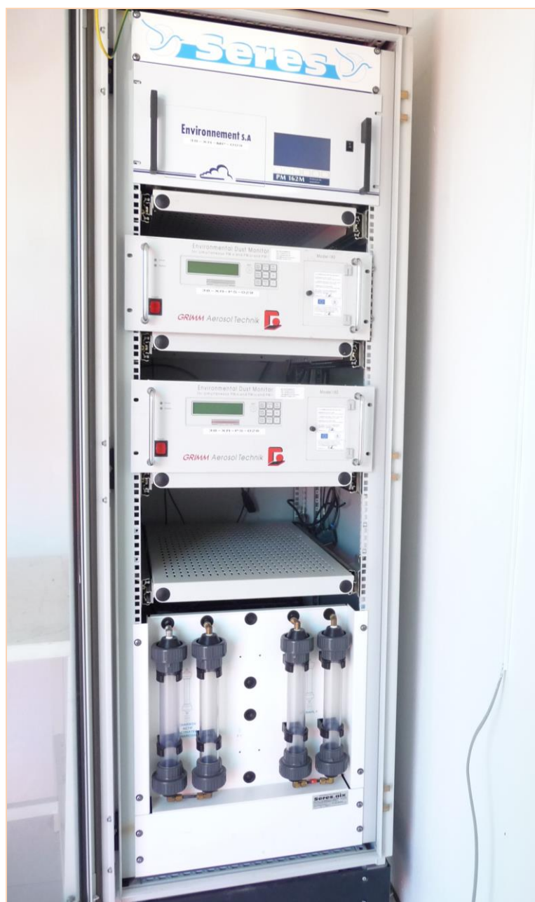
Figure 11 : Photographie de la baie sur laquelle était installé l'analyseur \text{SO}_2 de la station TIT.
