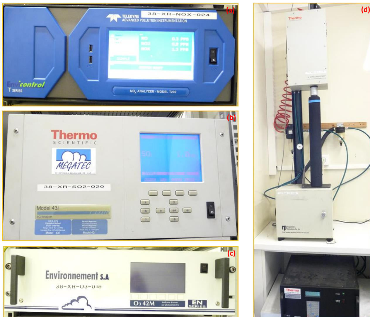
Figure 3 : Photographie des analyseurs NO x (a), SO 2 (b), O 3 (c) et PM 10 (d) en fonctionnement dans la station MAR.
