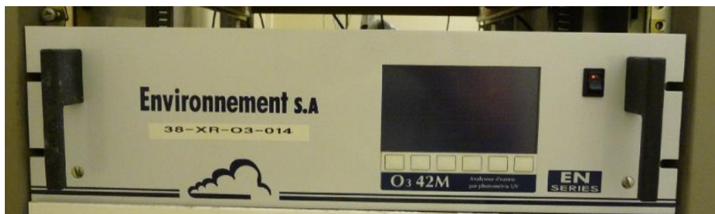
Figure 3 : Analyseurs O 3 en fonctionnement dans la station MON ( Crédits photos : ©Atmo Réunion, 2020).
