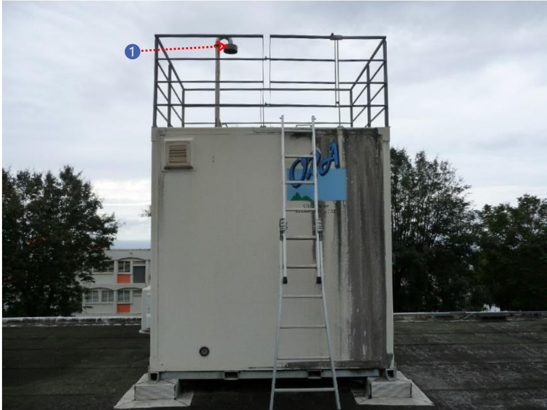
Figure 14 : Têtes de prélèvements sur la station MON (orientation Sud) (Crédit photo : ©Atmo Réunion, 2020).
