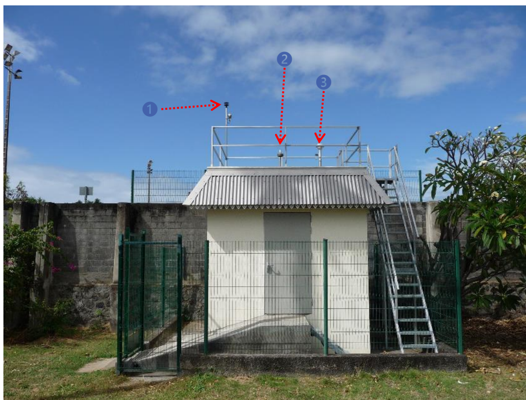
Figure 15 : Têtes de prélèvements sur la station LIS (orientation Est) (Crédit photo : ©Atmo Réunion, 2020).
