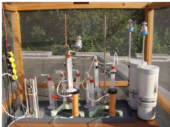
Photo 2 : Equipement ayant servi au prélèvement des fractions particulières et totales en vue de l'analyse des métaux réglementés
