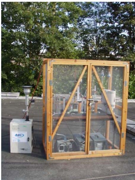
Photo 2 : Equipement ayant servi au prélèvement des fractions particulières et totales en vue de l'analyse des métaux réglementés
