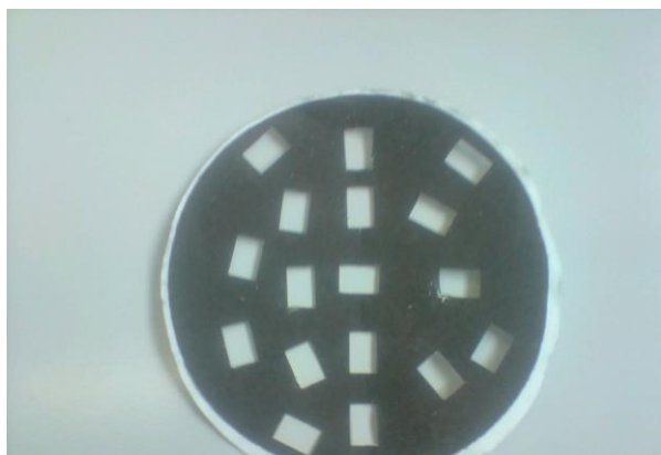
Photo 1 : filtre après 14 poinçons – La pliure du filtre est sur l'axe vertical (5 poinçons ont été réalisés sur cette pliure)
