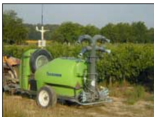
Pulvérisateur pneumatique utilisé pour le traitement de la vigne
