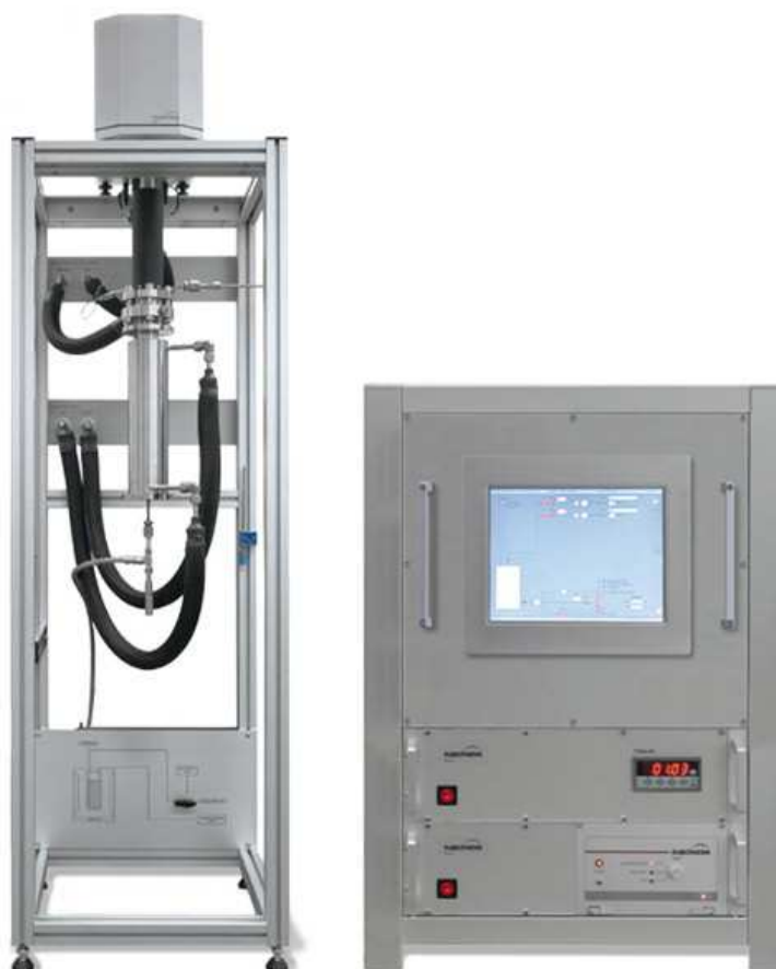
Figure 3 : Balance à suspension électromagnétique version « acier inoxydable » (Rubotherm)
