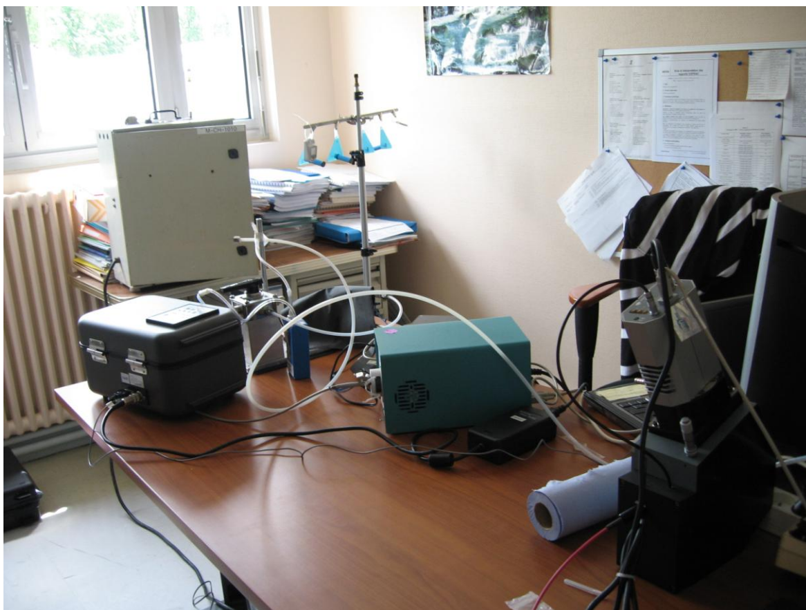
Figure 15 : Dispositifs de prélèvement et de mesure du formaldéhyde dans un bureau de l'INERIS.
