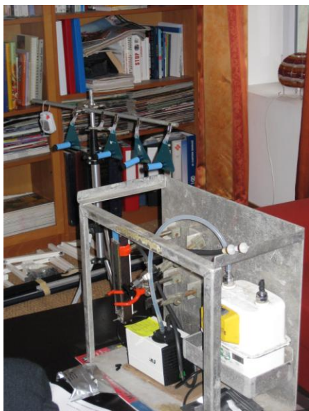
Figure 17 : Dispositifs de prélèvement et de mesure du formaldéhyde dans la MAISON 1.
