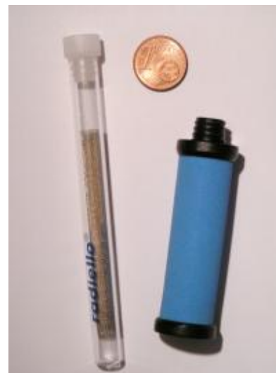
Figure 4 : Photographie d'une cartouche Radiello® code 165 (gauche) et du corps diffusif dans lequel elle doit être introduite pour le prélèvement (droite).
