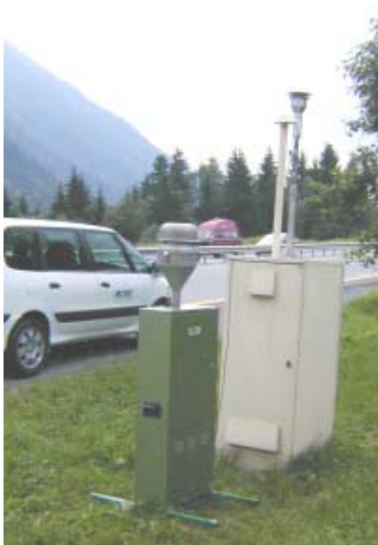
Figure 1. DA-80 de l'INERIS et cabine de l'Air APS au Bossons
